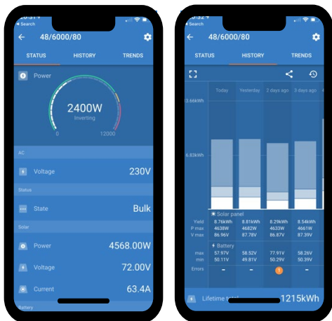
Konfigurointi ja valvonta VictronConnect-sovelluksen avulla Sisäänrakennettu Bluetooth Smart-liitäntä mahdollistaa helpon ja nopean valvonnan sekä Inverter RS:n asetuksien muokkaamisen.
